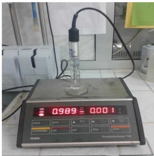
Figure II.8: Appareillage de Conductimètre.
